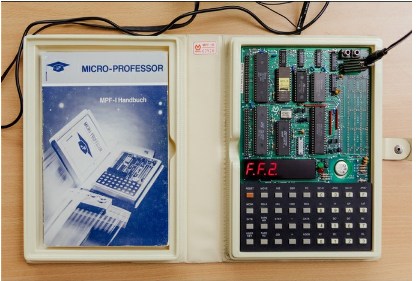
Einer der ersten Trainings-Einplatinencomputer "Microprofessor". © Jana Dünnhaupt
